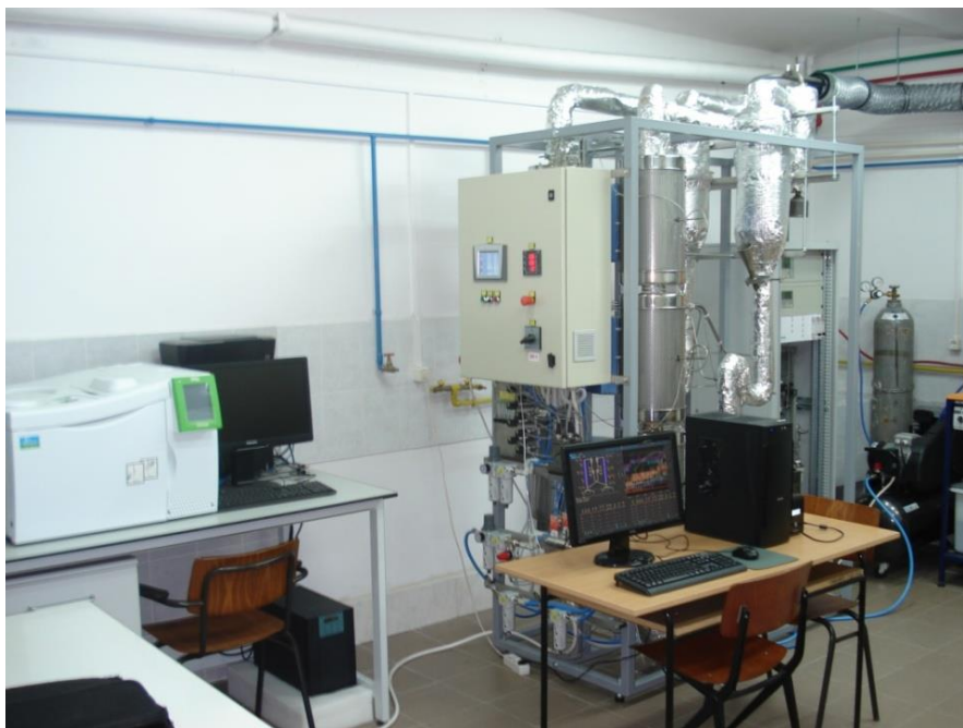
Figura 2 Instalația fizică a demonstratorului de laborator pentru tehnologia calcium looping
